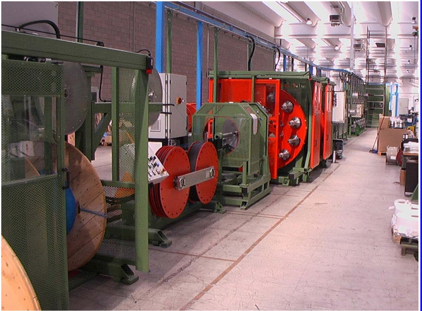
**Ligne apte à la réunion aux pas alternés S-Z, de câbles à fibre optique, composé par tube loose o fibres tight.**
